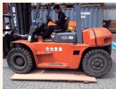
仓库同事在收货时根据进货质量控制程序的要求进行8吨叉车模拟承载测试
