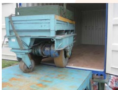
栢坚的集装箱地板在接受7,260承载力测试
